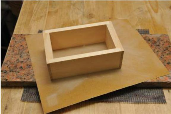
段差はカンナで修正し、平らな石盤（定盤）上でサンダーがけすれば、上面／底面とも平らに仕上がる。この石盤はカンナの刃を研ぐ砥石を平らにするときのもの。次に、箱の周囲をカンナがけして仕上げる。ブロックプレーンと No.4 ベンチプレーンで仕上げる。
