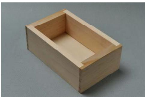
包み継ぎの箱を作ろう。写真のように短い方の板に段欠き加工するだけで作れる。
