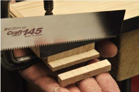
直角ガイドから剤を 10mm出してクランプし、段欠き部分を切り落とす。この時の10mm出す方法だが、写真のように長い方の材をあてがい、現物を利用してセットするとより正確になる。
