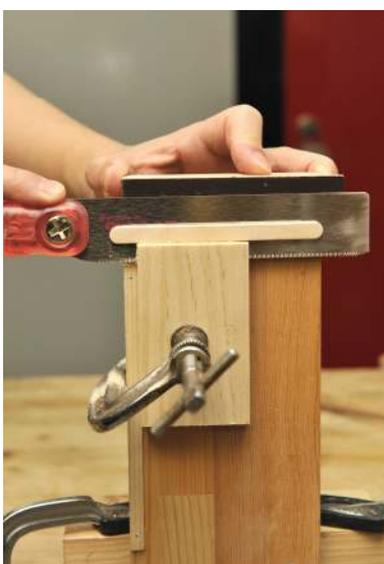
ベース板に材をクランプし、深さ 10mmの切込みを入れているところ。ノコ刃の後ろに少し見えるこげ茶色の部分は 5mm厚のスペーサー。これにより、板の前面から 5mm離れたところに切込みを入れることができる。切り込んだら、段欠きし、切り落とす部分に×印をつけておこう。
