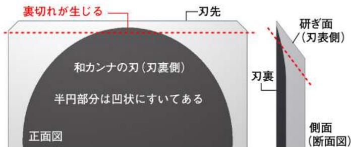
ので、再度刃をつけることになる。それが裏打ち・裏出しという修正作業。裏打ちはしのぎ面（研ぎ面の意）を金づちで叩く作業。これにより反対側、つまり刃裏側を少し押し出し、そこを金盤（かなばん）上で平らに削る。これが裏出しで、新しい刃がつくことになる。この作業は金づちで刃先を叩いて、欠いてしまう危険性や、地金を叩いても押し出す量が多すぎ、刃先にヒビが入ってしまうことがあるため、高度な熟練技術が求められる。和ガンナを使い続ければ、いつか「台直し」、「裏打ち・裏出し」に直面することになり、克服しなければならない。西洋ガンナには基本的にそれがない。この点が、総合性能に優れている所以だと考える。
