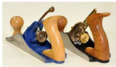
写真説明：写真 (上) は刃を外したカンナ。左がベイリースタイル。フロッグと本体を固定する2つのマイナスネジ頭が見える。このネジを緩めてフロッグを動かすため、刃を外す必要がある。一方、右がベッドロックスタイル。ネジの代わりに2つの金属ダボの頭が見える。このダボがフロッグを本体に押しつけている。フロッグを動かす場合は、写真 (下) のようにフロッグの裏側にあるネジを緩めて行う。これにより刃を外すことなく刃口の調整ができる。
