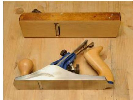
西洋ガンナでも安価なものは修正が必要なものもある。その場合、定盤上に貼ったサンドペーパーの上で修正を行う。カンナの底面は和ガンナと異なり平面でよい。修正に際しては底面にマジックインキで縞模様を描き、サンドペーパー上で縞模様が均等に消えるようになるまで削る。この修正は一度行えばいい。とは言え、購入するなら高品質のカンナをすすめる。安価なカンナに比べ、加工精度、刃の品質など全てが優れている。
