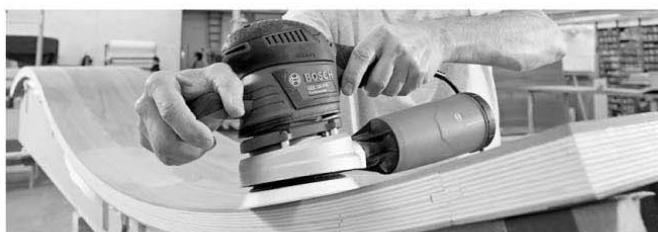
曲面の研磨は125mmφのペーパーで美しく仕上げられます。
