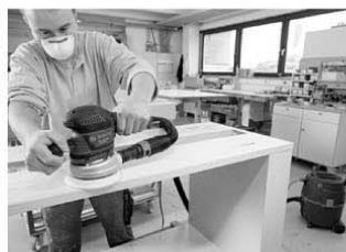
平面の連続研磨は、44%面積の広い150mmφのペーパーで効率良く作業が可能。
