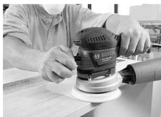
平面の連続研磨は、44%面積の広い150mmφのペーパーで効率良く作業が可能。
